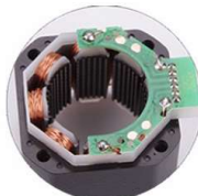
Permanent – Schrittmotor Schrittauflösung begrenzt – Hohes Drehmoment
